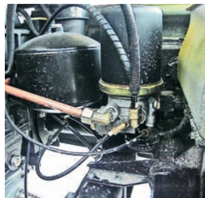
Блок подготовки воздуха – со сменным картриджем осушителя
