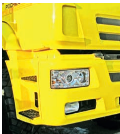
Все эти панели сделаны из прочной пластмассы – и нет никакой коррозии
