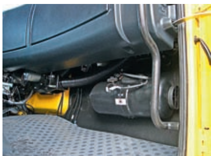
В кабине стоит и сухой «фен»-автономка. Опять большой плюс
