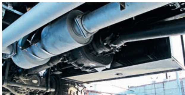
Все же для бездорожья глушитель лучше было бы смонтировать вертикально, на каркасе запасных колес
