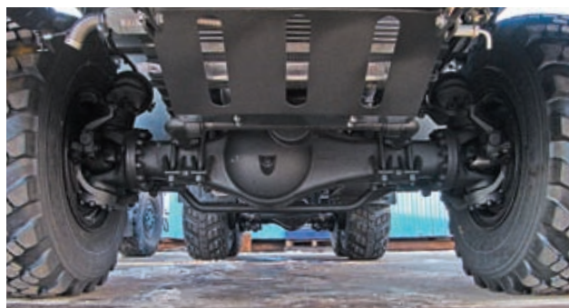
Радиатор надежно защищен стальной решеткой. Ступичные редукторы обеспечивают отличный клиренс
