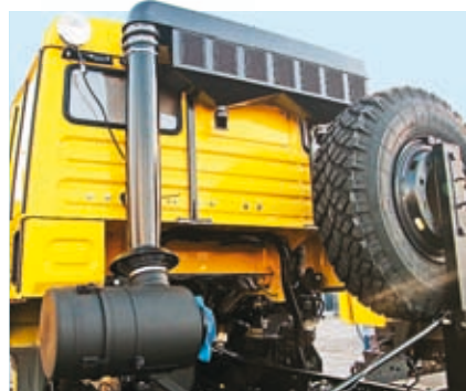
Воздушный фильтр дополнен предварительным фильтром-циклоном
