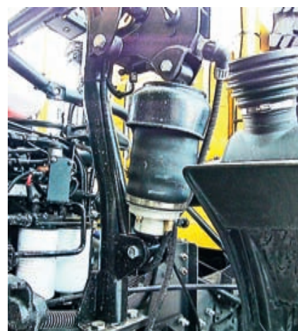
Четырехточечная пневмоподвеска кабины, оказывается, боится морозов...
