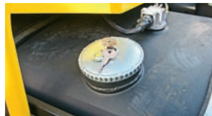
Топливный бак со стальным защитным листом снизу, а крышка – запирается на ключ
