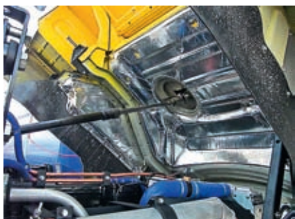
Управление коробкой ZF может быть выполнено телескопической тягой...
