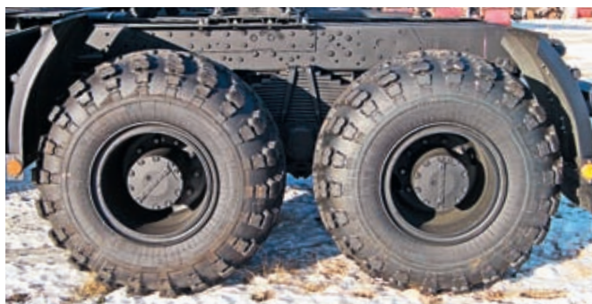
Такие же мосты ставят на самосвалы КАМАЗ-6520, но здесь «кразовские» шины, хотя и без регулировки давления...
