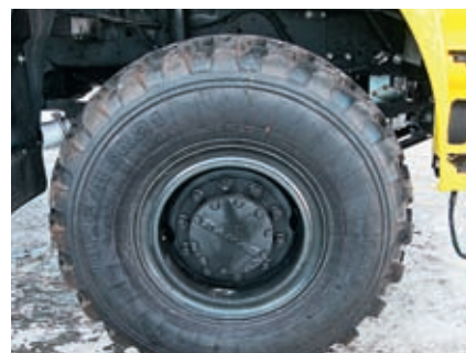
На переднем мосту тоже есть ступичные планетарные редукторы
