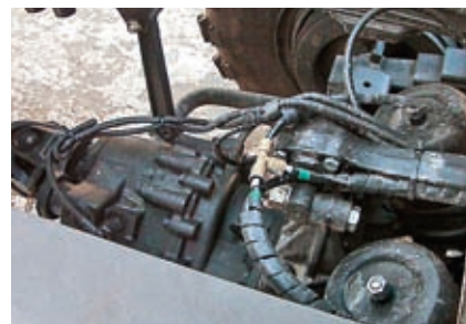
У редукторов среднего и заднего мостов есть блокировка дифференциалов
