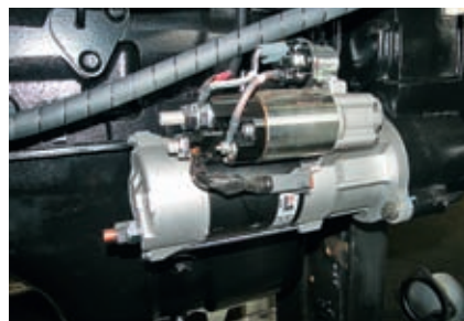
Стартер – редукторный, с постоянными магнитами. Мощный и легкий
