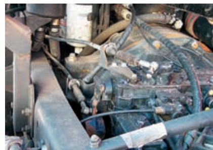
У тросов, в приводе коробки, надо следить за состоянием чехлов
