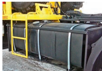
Топливный бак со стальным защитным листом снизу, а крышка – запирается на ключ
