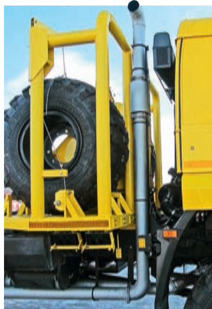
Этот трубчатый каркас нужен и для безопасности. Выхлоп выведен вверх!
