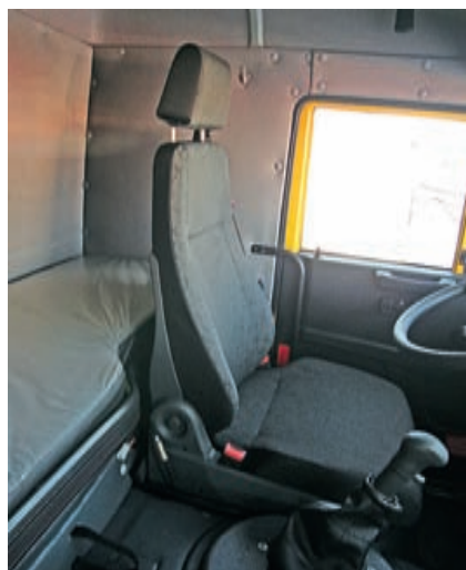
Кресло водителя с пневмоподвеской. А матрас сегодня уже кажется узким
