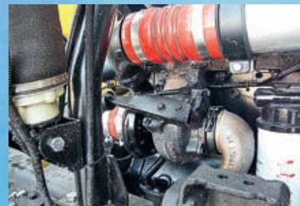
Это турбокомпрессор компании Holset, подразделения Cummins
