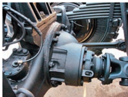
Редуктор заднего моста почти одинаков с передним, но есть блокировка
