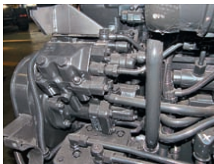
Шестерни ГРМ – переднего расположения. Здесь же стоит ТНВД
