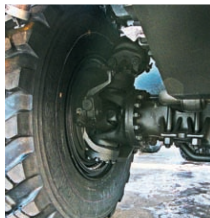
В переднем мосту в качестве ШРУСов применяют сдвоенные крестовины
