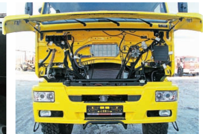
Фальшрадиаторную облицовку держат газонаполненные цилиндры – как на хороших грузовиках-иномарках
