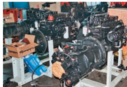
Коробку Fast Gear 9JS150T выпускают в КНР по лицензии Eaton Fuller
