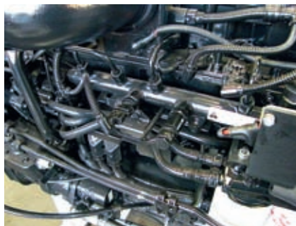
На Cummins ISL применяется топливная система Common Rail
