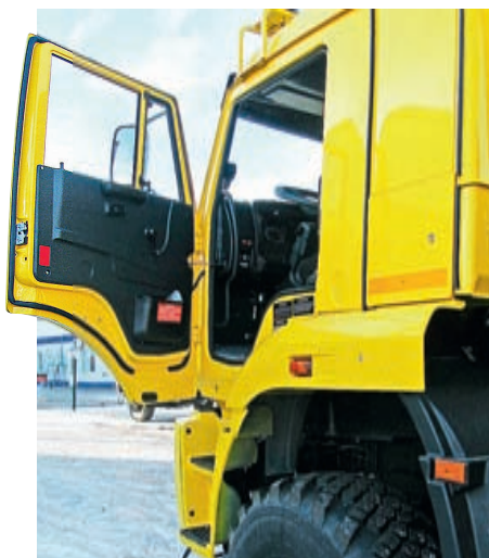
Для высокого тягача приходится дополнять две ступеньки «стременом»
