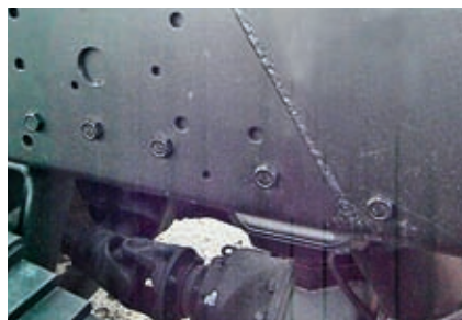
Раму в задней части наращивают вот с таким диагональным швом
