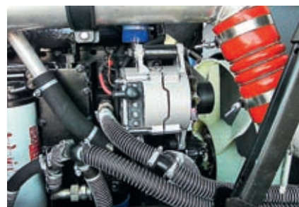
Генератор и стартер. Все навесное идет в комплекте с двигателем, из Китая
