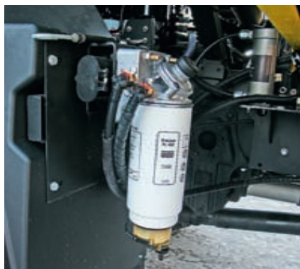
Топливный фильтр-отстойник – с ручным насосом и индикатором воды
