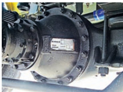
Передний мост с конической ГП и со ступичными планетарными редукторами
