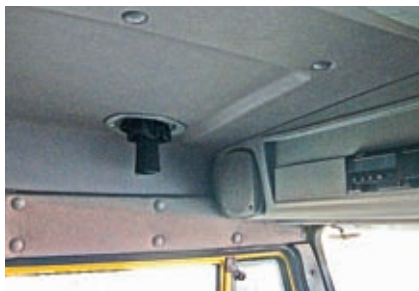
На крыше установлена фара-искатель, а ее ручка крепится на потолке
