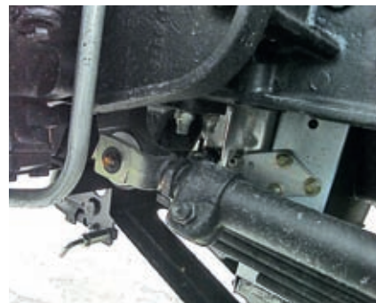
Передний шарнир продольной рулевой тяги – нового образца
