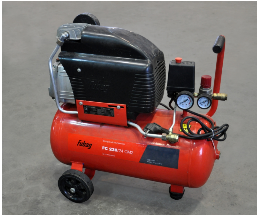
Мобильный компрессор мощностью 1,5 кВт.
