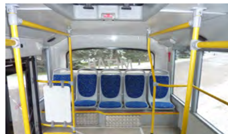
Полунизкопольная компоновка позволила разместить над двигателем пять сидений
