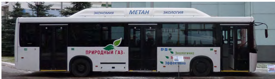
А это отечественный газовый автобус НефАЗ для городских маршрутных перевозок с емкостями для метана на крыше
