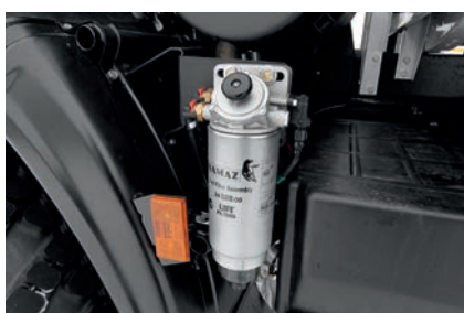
Топливный фильтр с водоотделителем – оригинальная камазовская запчасть, хоть и испанского производства
