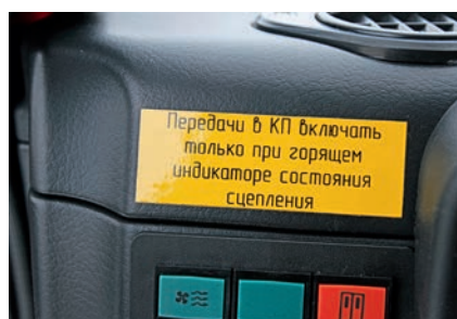
Привод выключения сцепления – не обычный, а электропневматический
