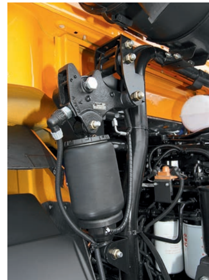
Камазовская кабина — на пневмоподвеске? РИАТ делает и такое
