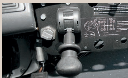
Под панелью – ручник, левее – выключатель пневморегулировки рулевой колонки
