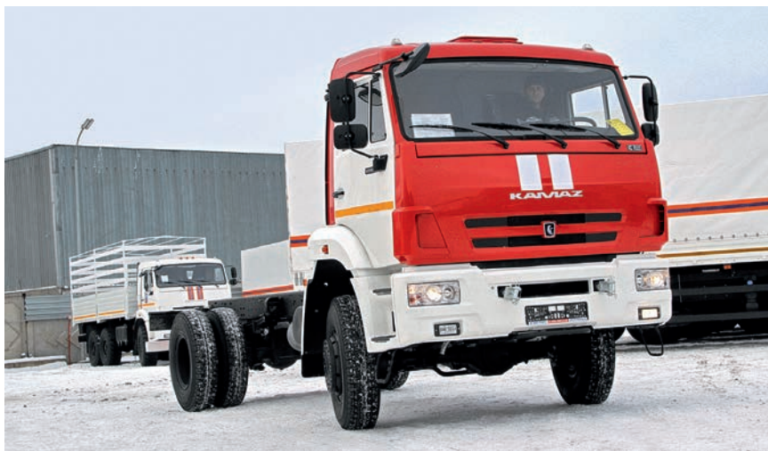
В гамме самого КАМАЗа нет полноприводного шасси с индексом 5387 и грузоподъемностью около 8,5 т. Потому что это – разработка РИАТа!
