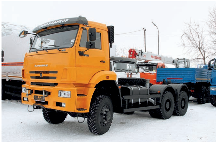
КАМАЗ-Ванкор 6x6 может быть и с двускатными задними колесами, и с односкатными
