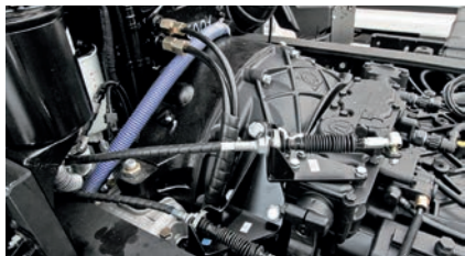
У механизма переключения коробки передач — тросовый привод...
