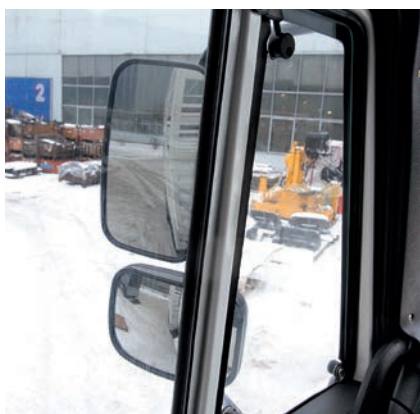
Стойка немного мешает виду через зеркала. Ничего не поделаешь!
