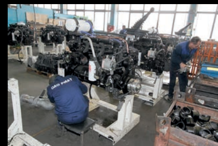
Китайские двигатели Cummins здесь состыковывают с коробками передач ZF челнинского производства
