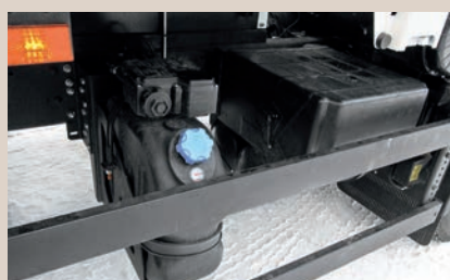
А вот и бачок с мочевиной, обязательный для двигателей Cummins ISLe Евро-4
