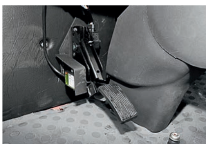
Привод выключения сцепления – не обычный, а электропневматический
