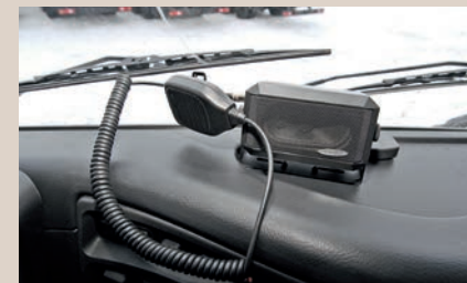
Радио входят в комплект навигационно-связного оборудования КУРС
