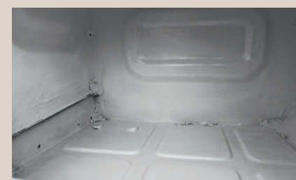
В вещевых ящиках виден грубо проложенный герметик. Неаккуратно!
