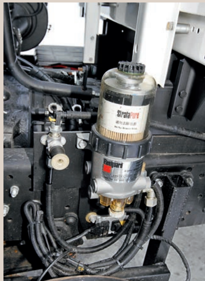
Здесь топливный фильтр с водоотделителем – уже из Китая, как и двигатель
