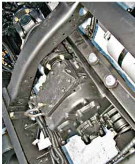
Раздатка с блокируемым межосевым дифференциалом, с пневмоуправлением
