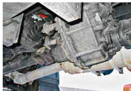
Применена обычная «камазовская» раздаточная коробка
