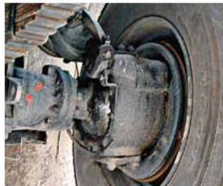
ШРУСы переднего моста закрыты почти герметично
