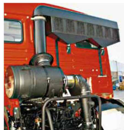
Воздушный фильтр дополнен небольшим «циклоном». Нужная вещь!
