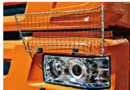
Решетки предохраняют от повреждения фары, а сзади – и фонари
