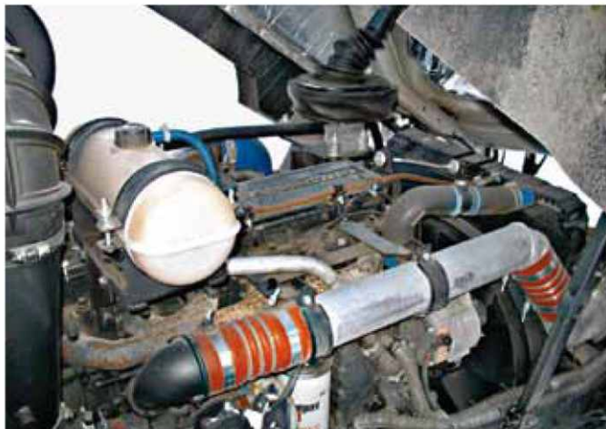
У дизеля Cummins ISLe топливная аппаратура – Common Rail, но нет ни рециркуляции, ни впрыска мочевины
