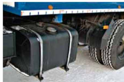
Топливный бак может быть и больше чем 210 л – вплоть до 500 литров
