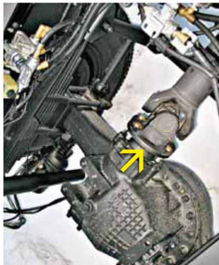
Фланцы карданов выполнены с торцевыми шлицами, по стандарту ISO
