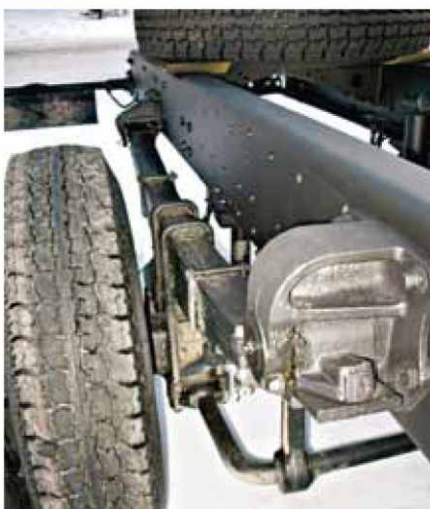
Задняя рессора – со скользящим задним концом и без подрессорника
