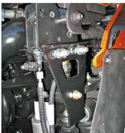
Подвеска кабины на древних полурессорах, но с гидрозамками
