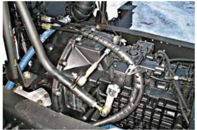
Коробка передач современная, 9-ступенчатая ZF, которую делают на СП «КАМА ЦФ» в Набережных Челнах
