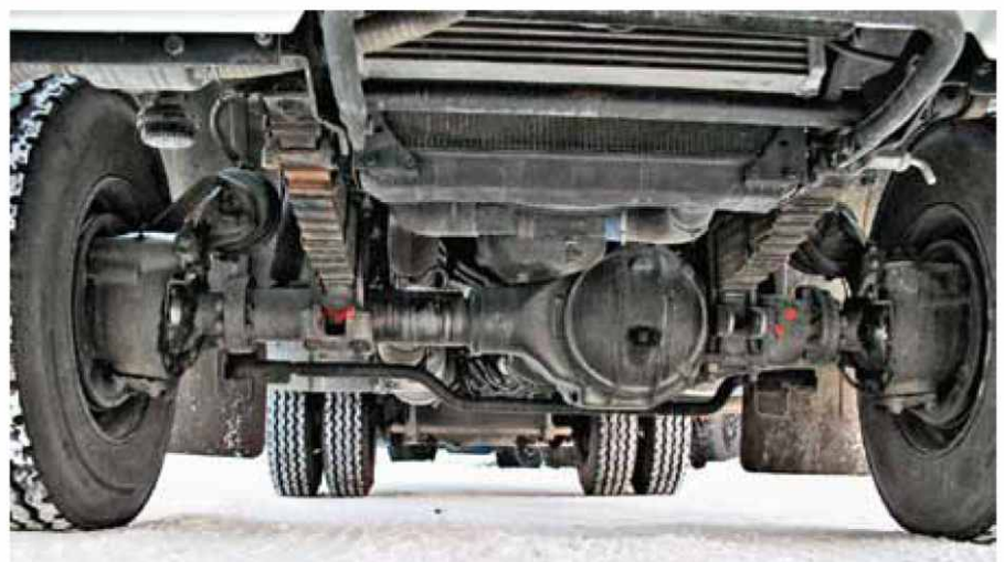
Передний ведущий мост от трехосного КАМАЗ-65111 6x6, рассчитан на нагрузку 6,2 тонны. Не помешал бы стальной защитный лист для радиатора
