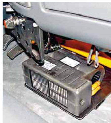
Дополнительную жидкостную печку устанавливают под панелью приборов
