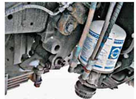
Передние рессоры с накладным ушком простые, недорогие, удобные в ремонте
