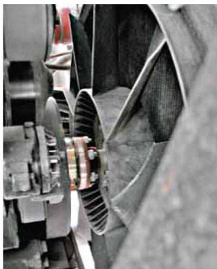
Вентилятор с вязкостной муфтой и поликлиновым ремнем
