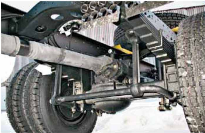
Редуктор заднего моста двухступенчатый, ведет свою родословную от редуктора 4320, поэтому и кардан стоит высоко
