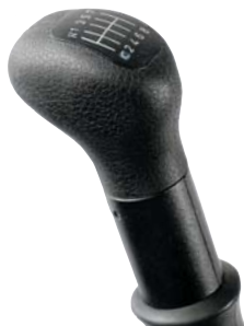
Рис. 2 ZF схема переключения двойное Н и рычаг переключения передач
