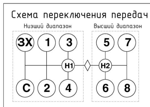
Схема переключения передач в коробке передач модели Fast Gear 9J5135 TA
